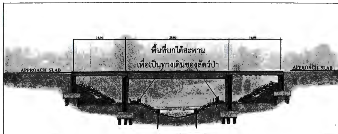
รูปที่ 2.2-1 ตัวอย่างการออกแบบพื้นที่บกได้สะพานของสัตว์ป่าขนาดเล็ก
